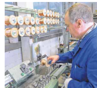
In der Spinnerei werden die Basssaiten mit Kupfer umwickelt. FOTO: OH
